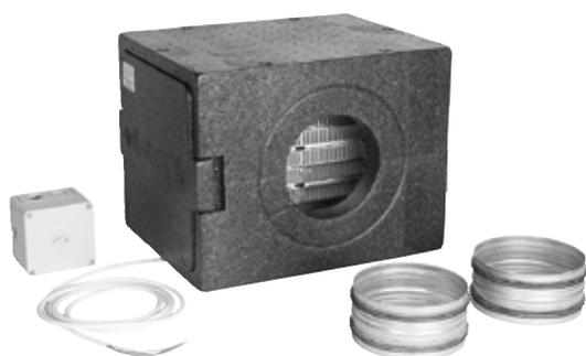
Eelkütteelement EPP kasti koos integreeritud PTC-kütteelemendi ja G3-õhu-filtriga. Paigaldatakse välisõhu-kanalile enne ventilatsiooniseadet.
