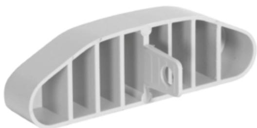
Reguleerimiselement võimaldab tasakaalustada rõhukadu õhujaotussüsteemis. Reguleerimiselement paigaldatakse profi-air® tunneltoru tihendus- ja ühenduselementi.
